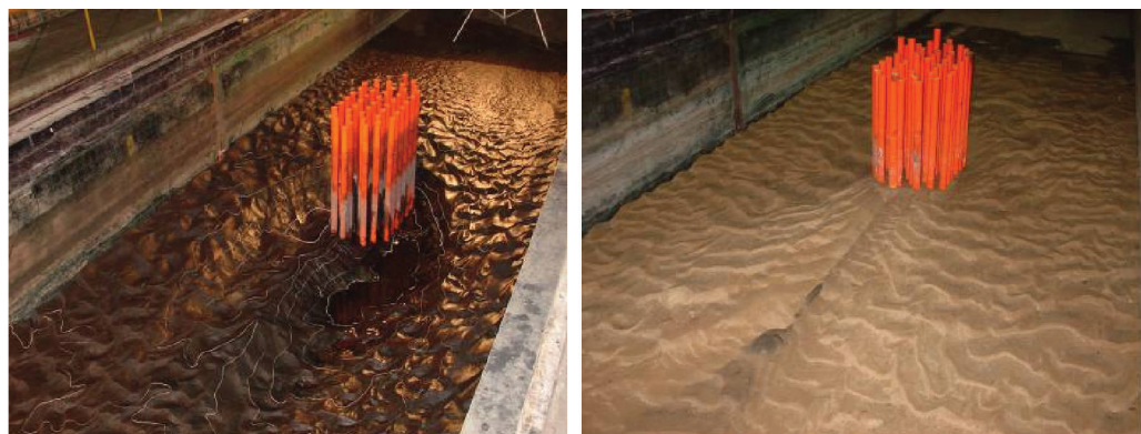
Figura 4.- Vista desde aguas abajo de la fosa de socavación en modelos de carbón y arena
